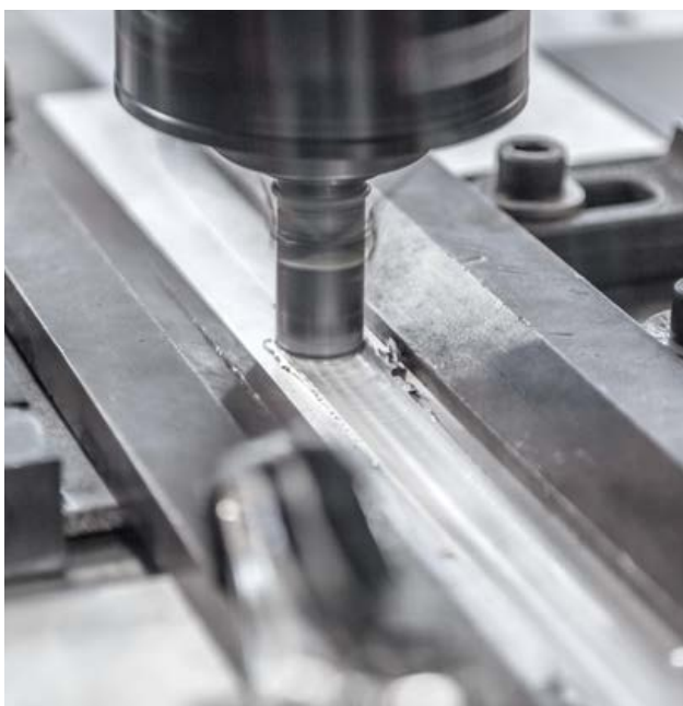
Gratbildung beim Rührreibschweißen infolge eines Wärmestaus
