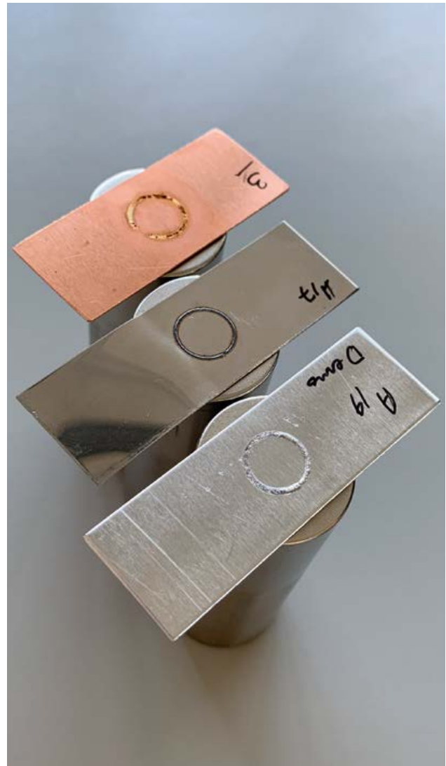
Lasergeschweißte Stromableiter (Kupfer, vernickelter Stahl, Aluminium) auf zylindrischen Zellgehäusen
