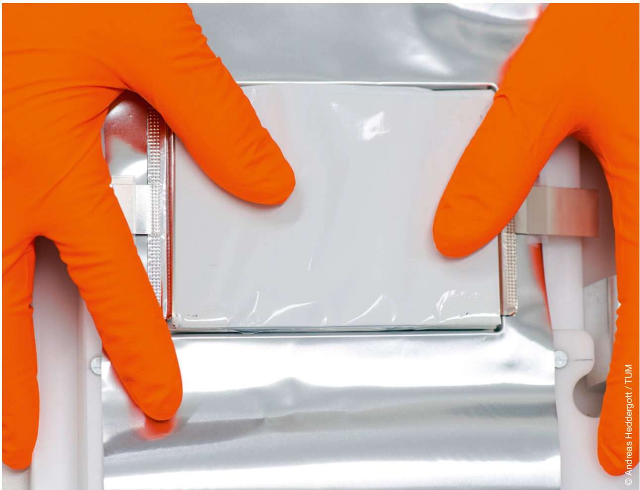
Z-gefalteter Zellstapel beim Verpackungsschritt in eine Pouch-Zelle im Trockenraum des iwb
