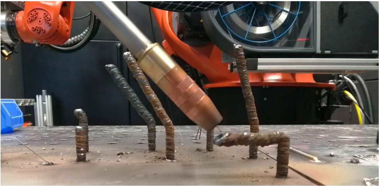
Ausschnitt eines WAAM-Prozesses bei der Fertigung von überhängenden Bauteilstrukturen;
