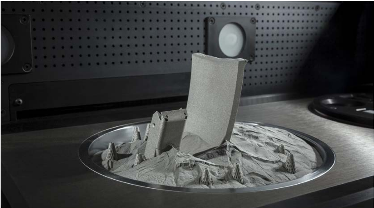
Abbildung 1: Baujob nach der Fertigung auf der neuen Trumpf TruPrint 2000 des iw b.
