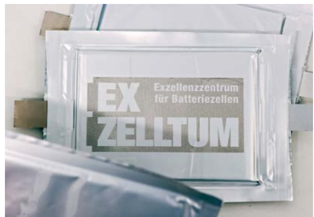
Batteriezellen hergestellt in der Produktionslinie des iwb
