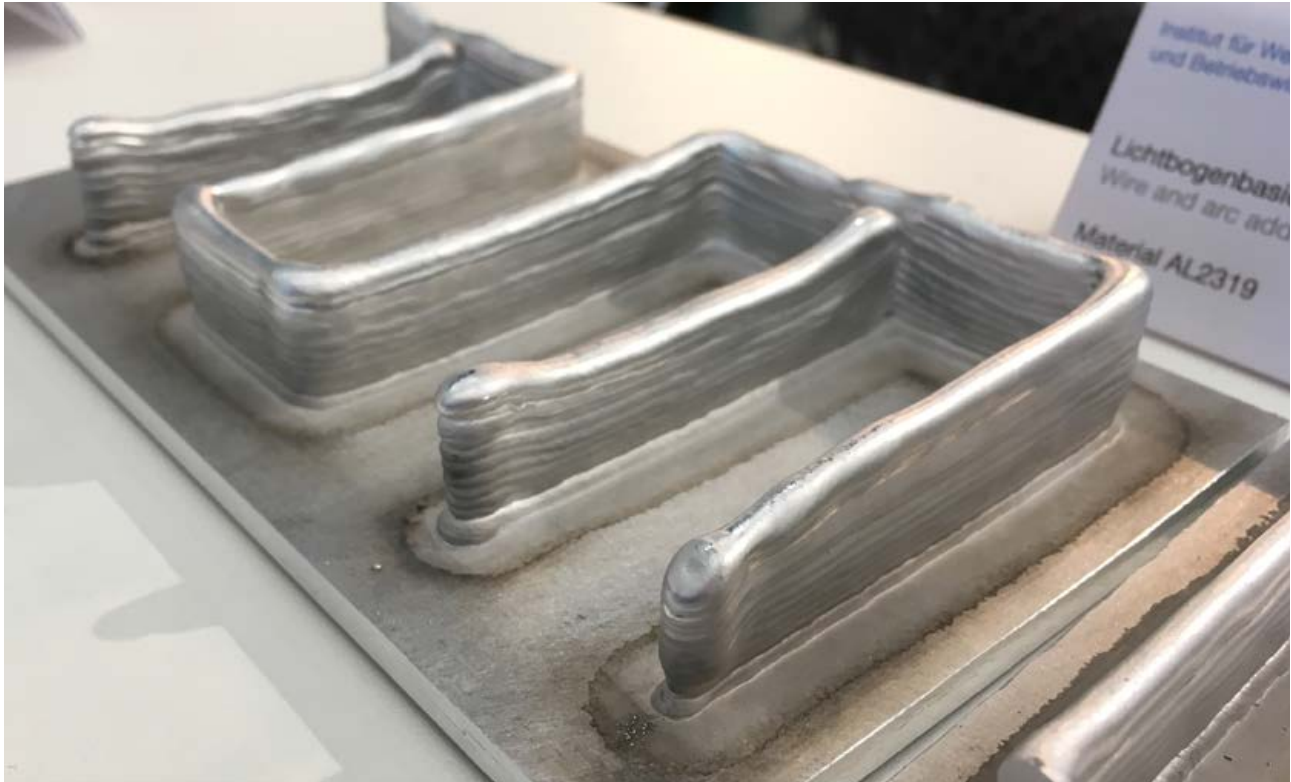
Ein am iwb gefertigtes Demobauteil aus dem Bereich der lichtbogenbasierten additiven Fertigung
