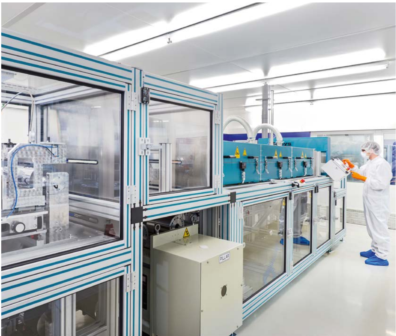
Beschichtungsanlage zur Herstellung von Batterieelektroden (Quelle: Andreas Heddergott, TUM)
