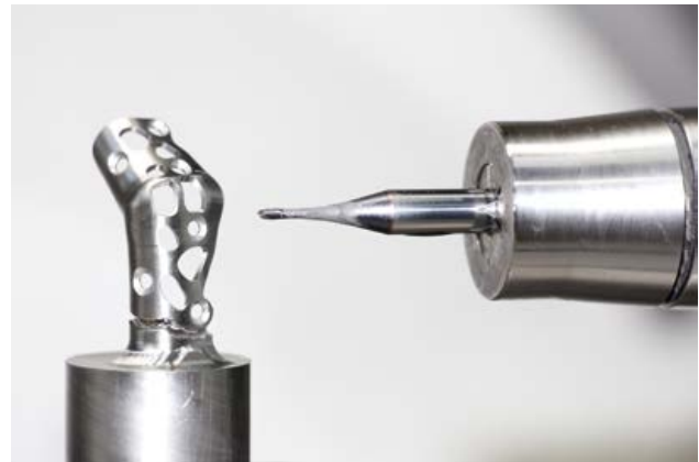
Automatisiertes Fünf-Achs-Simultanfräsen eines topologieoptimierten, patientenindividuellen Implantats
