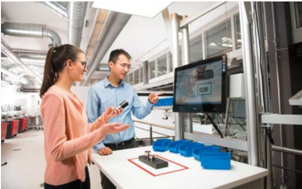
Kamerabasiertes Montageassistenzsystem „Schlauer Klaus“ am iwb (© Tobias Hase, Fakultät für Maschinenwesen)
