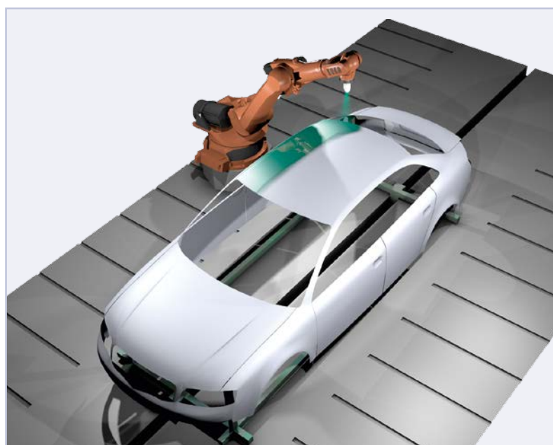
Partikelbasierte Fluidsimulation am Beispiel eines Lackierprozesses
