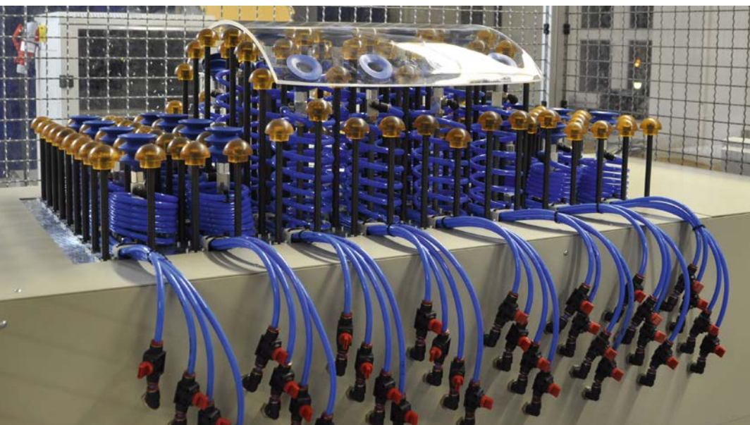
Flexibles Spannsystem zum Spannen von Kunststoffplatten
