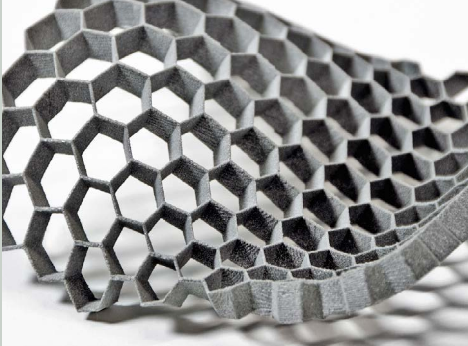
Additiv gefertigte Freiform-Wabenstruktur
