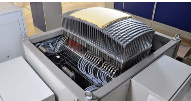
Flexibles Formwerkzeug für Kunststoffplatten
