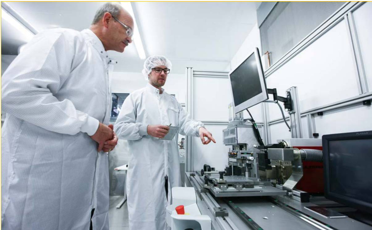
Im Trockenraum der Forschungsproduktionslinie für Lithium-Ionen-Zellen
