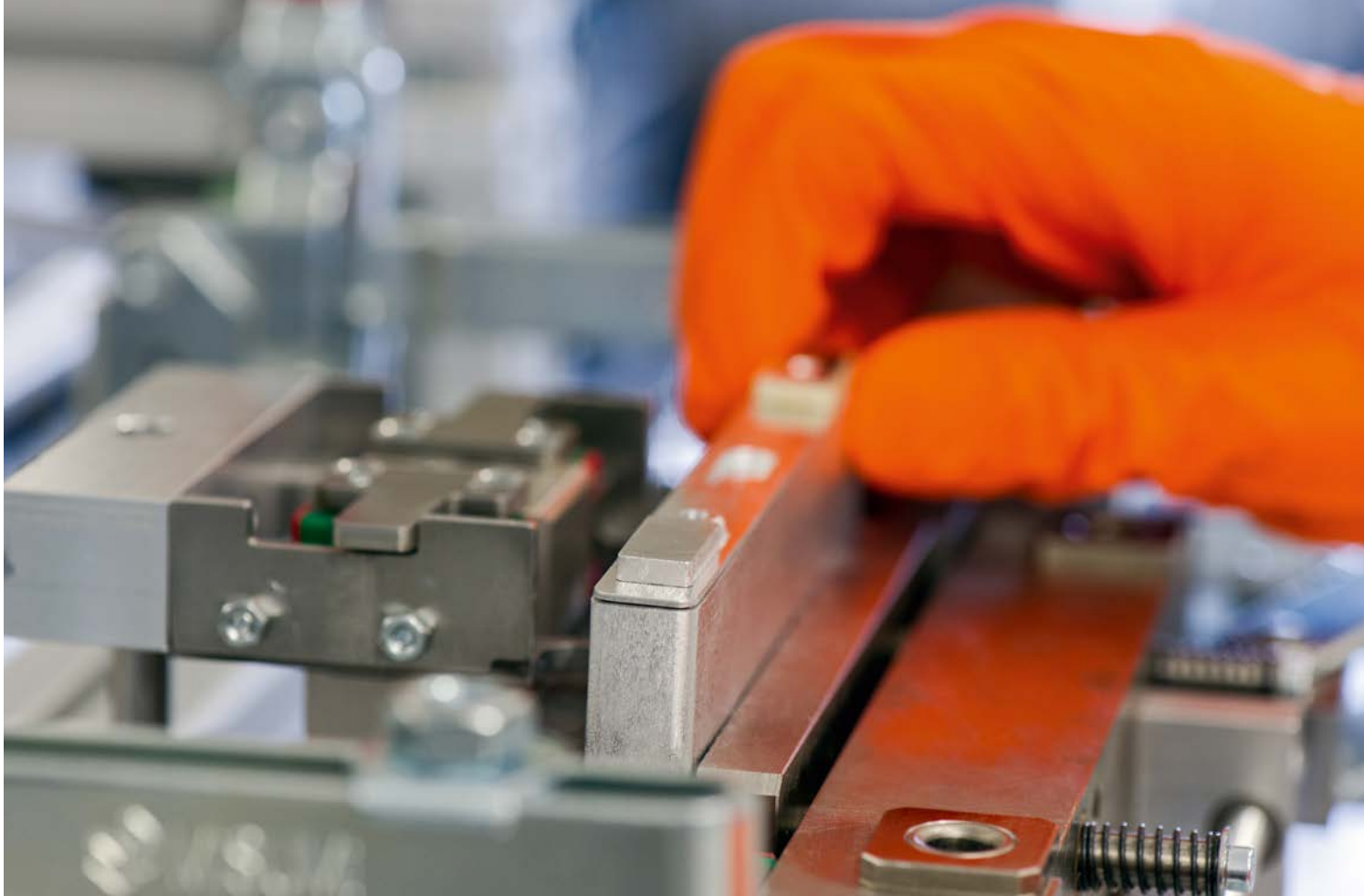
Vorbereitung einer Hardcase-Zelle für das Fügen von Deckel und Gehäuse mittels Remote-Laserstrahlschweißen. (A.Heddergott/TUM)
