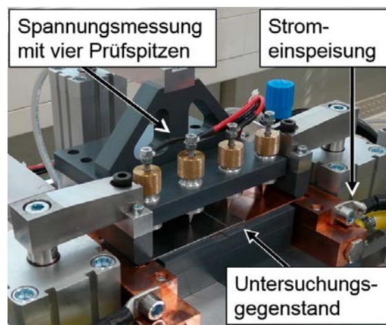
Prüfstand zur Messung des elektrischen Verbindungswiderstandes
