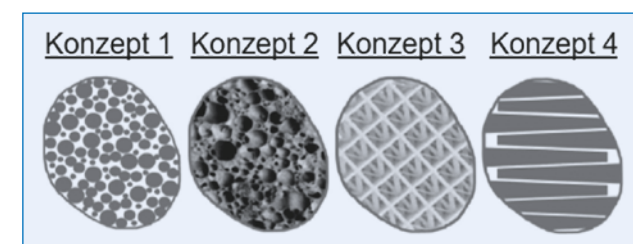
Abb. 1: Vier additive Dämpfungskonzepte
