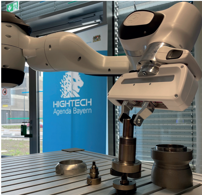
Abb. 2: Demonstration der teleoperierte Getriebemontage bei der Eröffnung des Siemens Technology Center am TUM Campus Garching (Bild Theresa Prinz/TUM)
