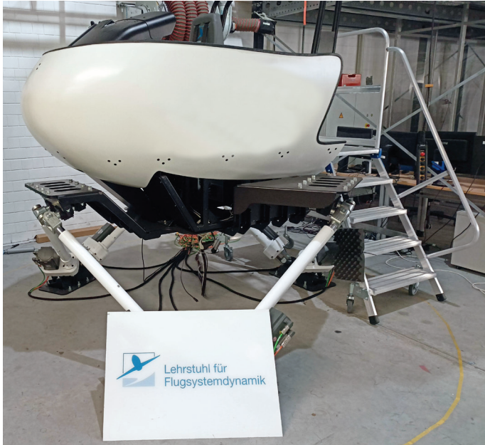
Abbildung 1: Mixed-Reality-Simulator zur Verwendung im Projekt ARA-SVO. Mit freundlicher Genehmigung des Lehrstuhls für Flugsystemdynamik, Technische Universität München.
