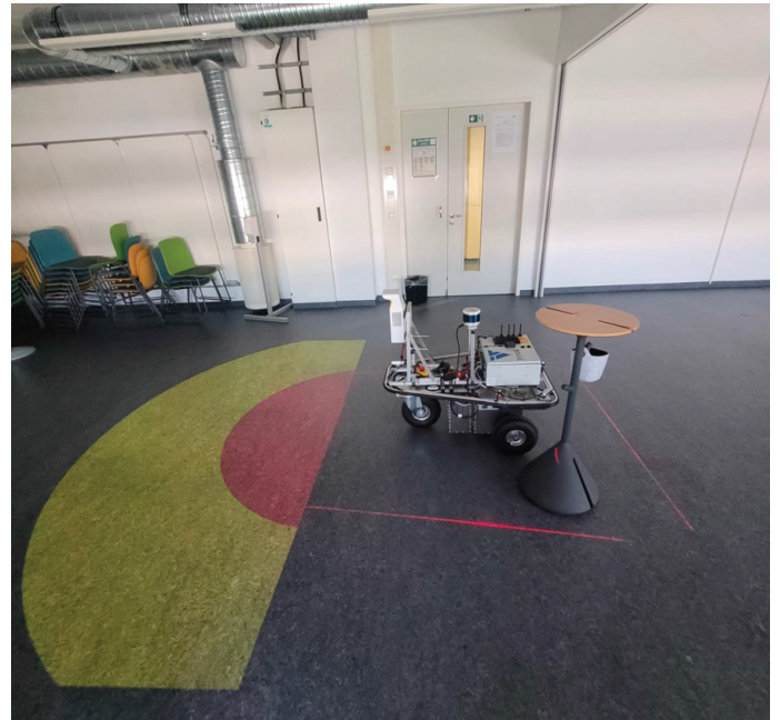
Abbildung 2: Visuelle Kommunikation von Schutzfeldverletzungen mittels Kurzdistanzbeamer und Linienlasern
