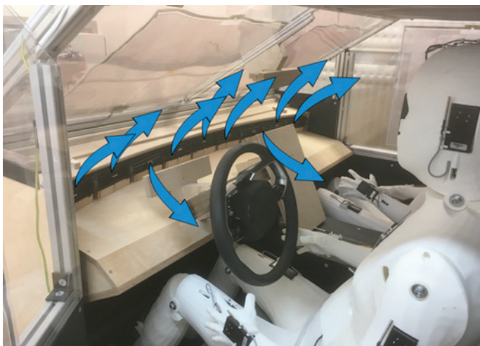
Abbildung 1: Innovatives Ausströmkonzept für hochautomatisiertes Fahren.
