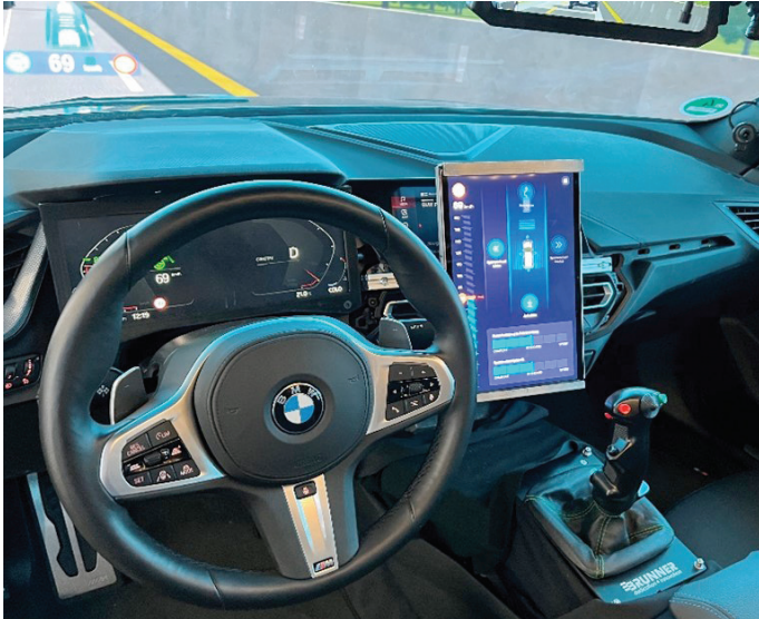
Abbildung 1: Integration der beiden entwickelten Interaktionschnittstellen zur Zusammenarbeit zwischen Mensch und Automation in einem Fahrsimulator.
