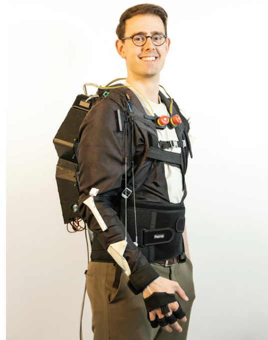
Abbildung 1: Laborprototyp des Lift&Carry.1 von HF.exo
