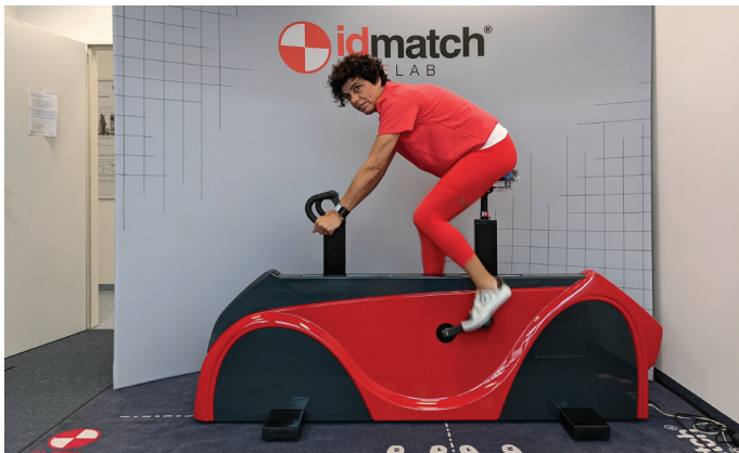
Abbildung 4: Messung der Druckverteilung bei einer Probandin auf dem Selle Italia idmatch system im SHER Projekt.
