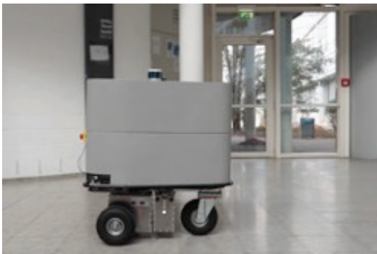
Abbildung 4: Innok Heros Roboterplattform (Innok Robotics) mit maßgefertigter, modularer Abdeckung (Zwei unterschiedliche Größen).
