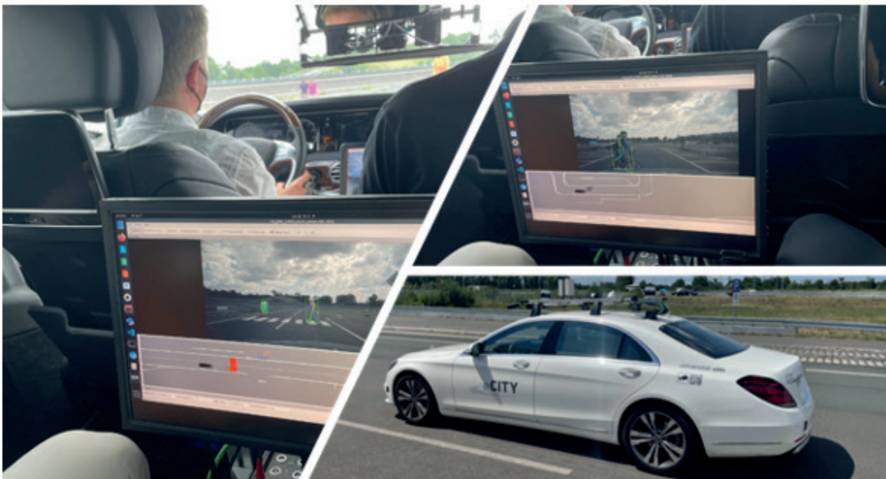
Abbildung 1: Versuchsträger auf der Teststrecke mit Demonstration der Identifikation und Prädiktion von Fußgängern und Radfahrern in Interaktionssituationen an einem Zebrastreifen bzw. auf einer Verbindungsstraße
