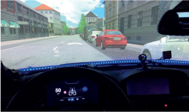
Abbildung 5: HMI-Konzept bestehend aus ARHUD, LED-Leiste in der Scheibenwurzel und freiprogrammierbaren Kombidisplay.
