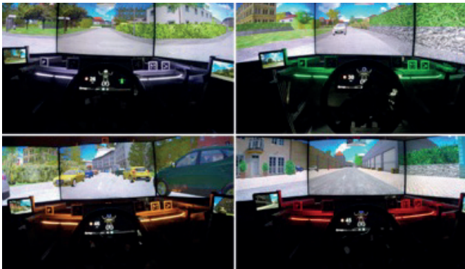
Abbildung 4: Farbcodierte LED-Leiste zur Anzeige der verbleibenden automatisierten Fahrzeit.
