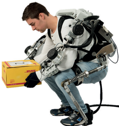
Abbildung 3 Prototypenaufbau der körpergetragenen Hebehilfe; Aufbau der Kinematik-Struktur des Systems durch die J. Schmalz GmbH (Oberkörpereinheit), das Fraunhofer IPA (Unterkörpereinheit); Steuerung/Regelung durch Sensodrive GmbH; Bedienkonzept durch LfE und Sensodrive GmbH (vgl. Knott & Bengler, 2017)
