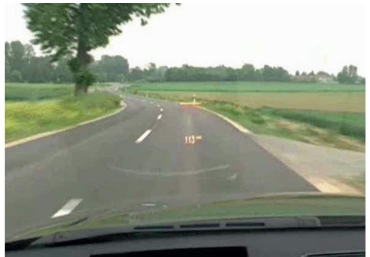
Abb. 13: Links: kontaktanaloge Anzeige des Sicherheitsabstandes (Bubb, 1980) - Rechts: kontaktanaloge Anzeige der „Fahrerschlauchs“, d.h. die Distanz des Abstandstriches wird durch die Geschwindigkeit, seine Querlage von der Lenkradstellung und der Geschwindigkeit bestimmt (Schneid, 2008; AUDI AG)
