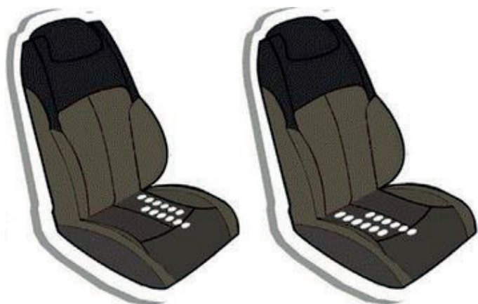
Abb. 7: Exemplarische Darstellung zur Anordnung der vibrotaktilen Elemente in der Sitzmatte (links: Aktivierung bei Gefahr von linkem Bordstein, rechts: Aktivierung bei Gefahr von rechtem Bordstein) (aus Petermeijer et al., 2017)
