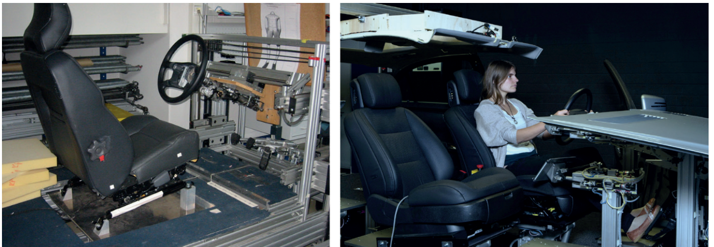
Abb. 9: Links: Fahrerstand (aufgebaut von der AUDI AG), mit dem ein wesentlicher Teil der Versuche für RAMSIS durchgeführt worden ist. Rechts: Modularer Ergonomieprüfstand (MEPS), eine Spende der Daimler AG.
