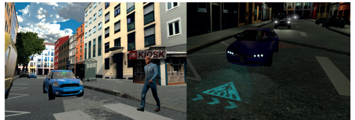
Abb. 2: Externe HMI Konzepte zur Kommunikation automatisierter Fahrzeuge mit Fußgängern. (Quelle: André Dietrich, TUM)
