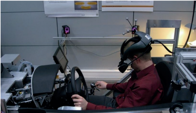
Abb. 5: Links: Anwendung des Helm-Mounted-Displays in einem variablen Fahrerstand (Riedl, 2012) - Rechts: Gegenwärtiger Fußgängersimulator am Lehrstuhl (Quelle: Sebastian Mast)
