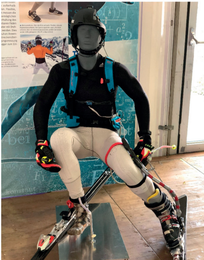
Abbildung 1: Skifahrerpuppe mit körpergetragenen Messsystemen
