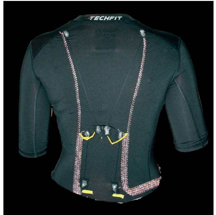
Abbildung 1: Sensor-Shirt mit Messfäden (TUM)
