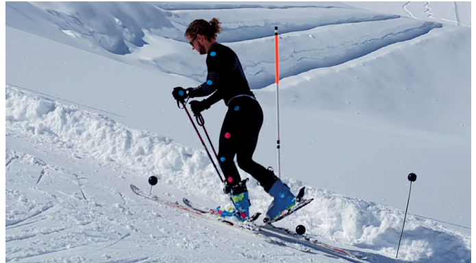
Abbildung 3: 2D-Bewegungsanalyse einer Tourenbindung
