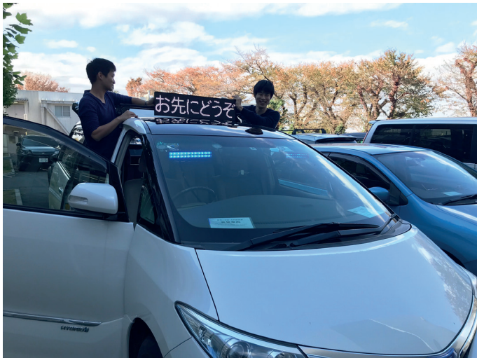
Abbildung 4: Versuchsträger mit externer Anzeige in Form von LED Schriftzeichen.
