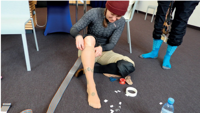
Abbildung 1: Anbringen von Druckmesssensoren
