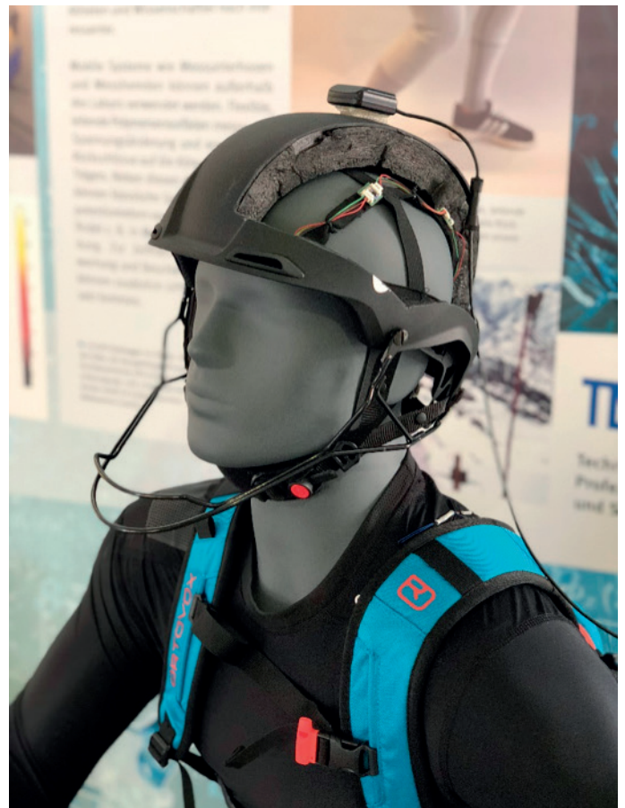
Abbildung 2: Sensornetz zur Messung des Mikroklimas unter dem Helm
