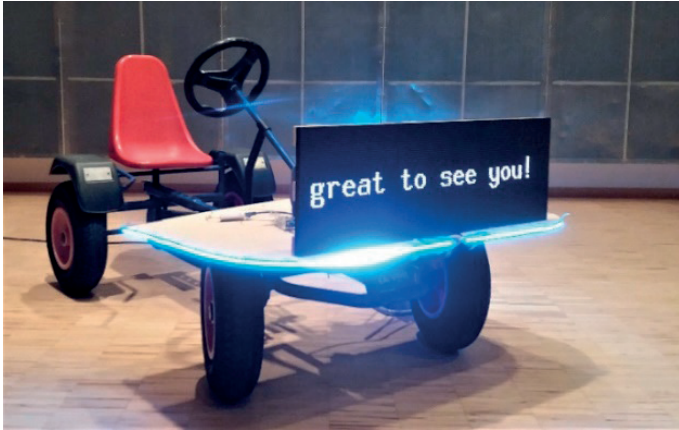
Abbildung 2: Prototypischer Aufbau der LED-Matrix und des LED-Streifens (Bildquelle: Robin Storm, 2019)
