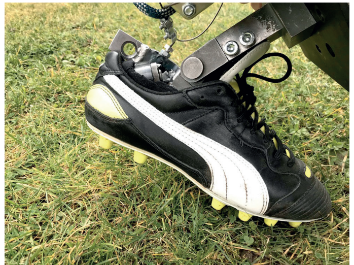
Abbildung 2: Mechanisches Fußmodell des TUM-TrackTesters
