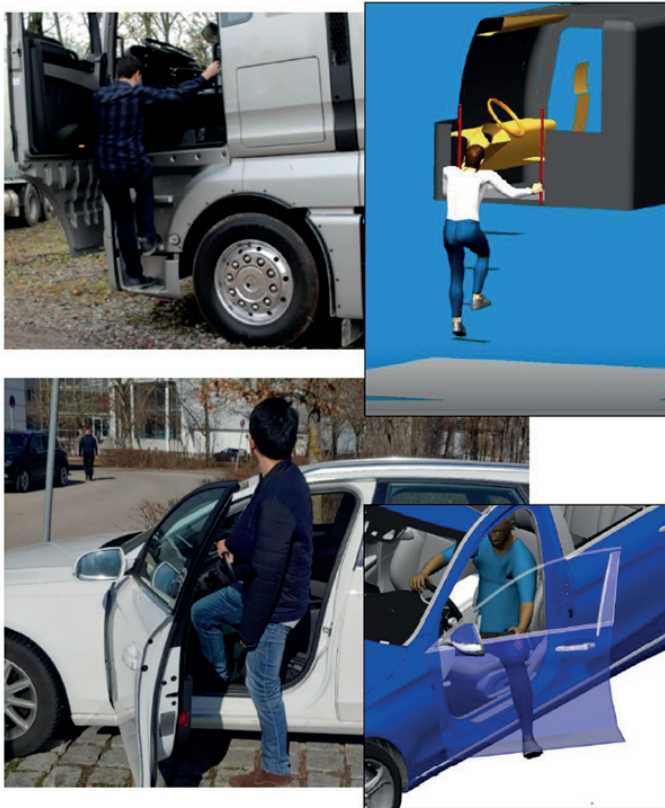
Abbildung 1: Auf der linken Seite ist der Einstieg oben in einen Lkw und im unteren Teil in Pkw zu sehen. Beide werden rechts modelliert und sollen zukünftig voraussagbar und bewertbar werden (Bildquelle: Eigene Darstellung).
