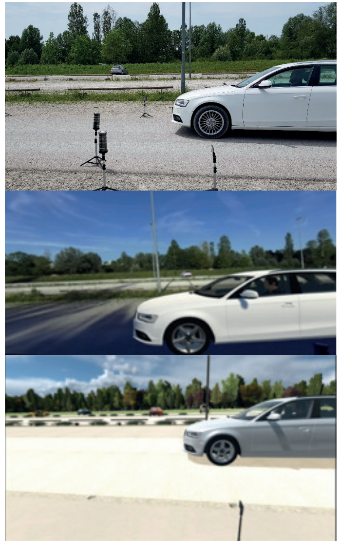
Abbildung 3 Oben: Reales Fahrzeug auf dem Testtrack Campusparkplatz Garching. Mitte: Virtuelles Fahrzeug augmentiert auf realer Umgebung via „Video Pass-Through“ (Screenshot aus Darstellung im Headset). Unten: virtueller Parkplatzumgebung mit virtuellem Fahrzeug in der VR Bedingung.
