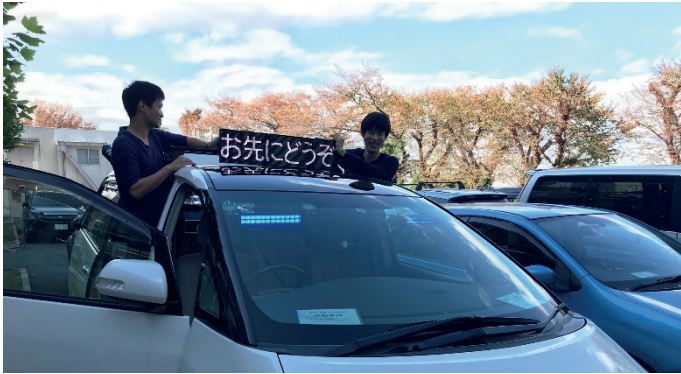
Abbildung 3: External HMI in Form einer japanischen Schriftnachricht auf einem automatisierten Versuchsträger an der Keio Universität (TUM)
