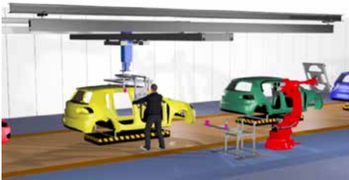
Abbildung 3: Anwendungsfall der Panoramadachmontage (Bildquelle: Fraunhofer IPK).
