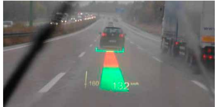
Abbildung 4: Adaptive Cruise Control (ACC)-Darstellung im AR-HUD (Schneid, 2008).
