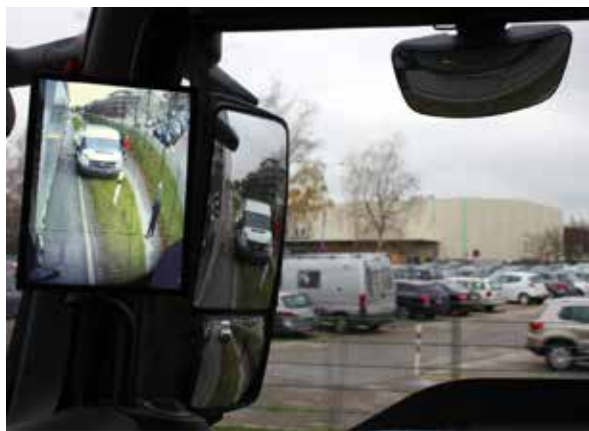
Abbildung 6: Die Sichtbereiche aller drei Außenspiegel werden in einer durchgängigen Anzeige dargestellt
