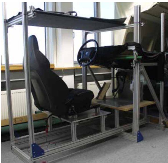
Abbildung 3: Aufbau für Sitzkomfortuntersuchungen am Lehrstuhl für Ergonomie
