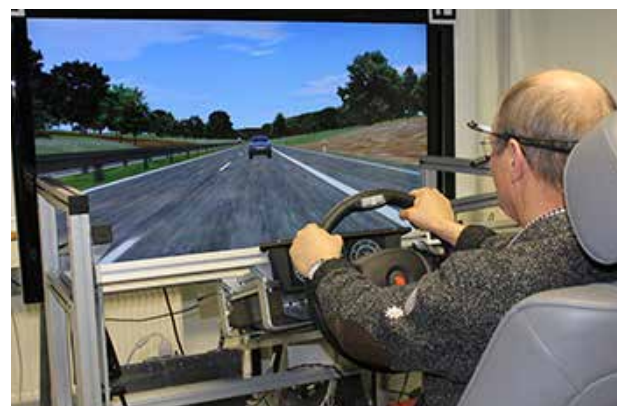
Fahrzeugfolgeaufgabe in der LfE-Sitzkiste (mobiler Fahrsimulator) mit Dikablis Eye-Tracking
