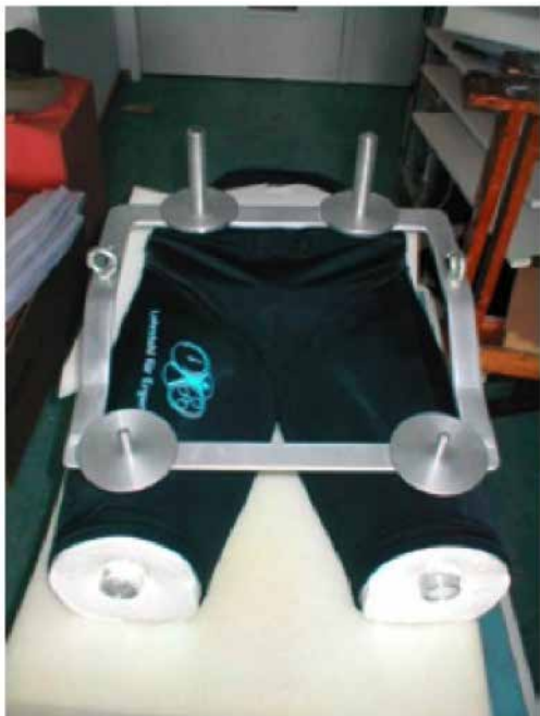
Abb. 1: Hardware-Dummy aus Silikon des Lehrstuhls für Ergonomie (Sabbah, 2008)
