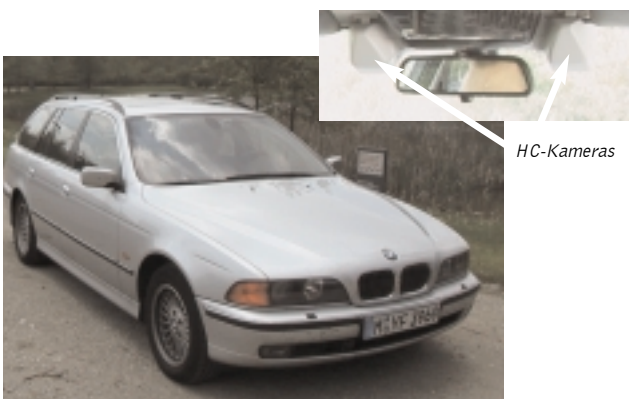
Abb.1: Das Versuchsfahrzeug, ein BMW 540iA, sowie die eingebauten Heading Control Kameras.
