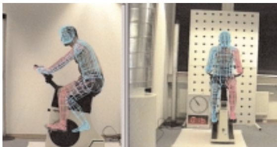
Abb. 5: Weiteres Folgebildpaar. Wie im Vorbild errechnete die Bewegungsverfolgung die neue Haltung. Nach diesem Prinzip wird sukzessive ein ganzer Film analysiert und jede Haltung berechnet.
