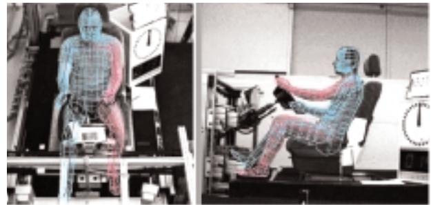
Abb. 2: Vermessung einer Fahrerhaltung mit Hilfe des zuvor erzeugten Modells.
