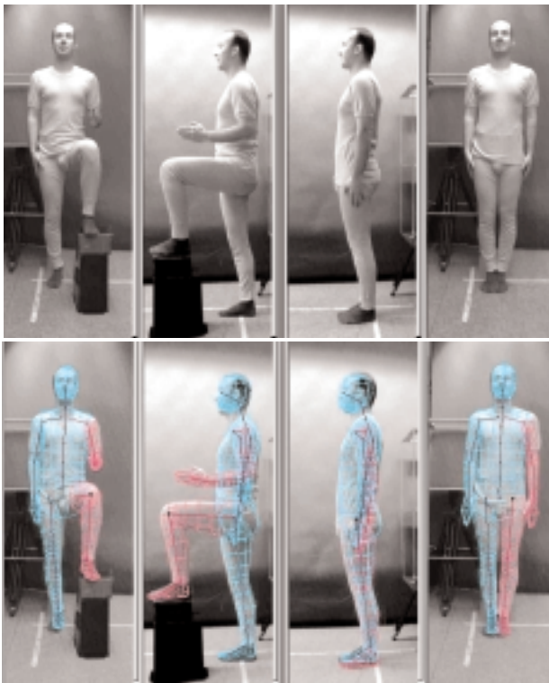
Abb. 1: Oben: Aufnahmen einer Versuchsperson in zwei Haltungen. Unten: Überlagerung eines korrekten dreidimensionalen Abbilds der Versuchsperson.
