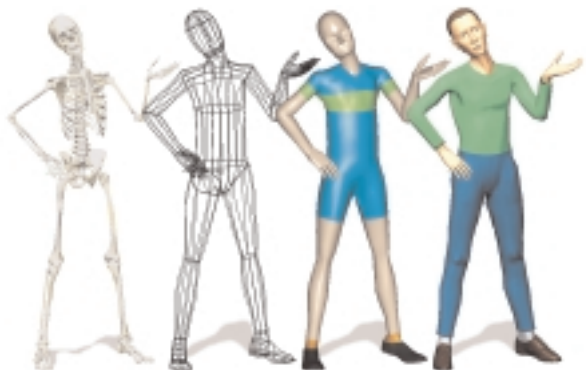
Abb. 2: Das Menschmodell RAMSIS in seinen unterschiedlichen Darstellungsformen
