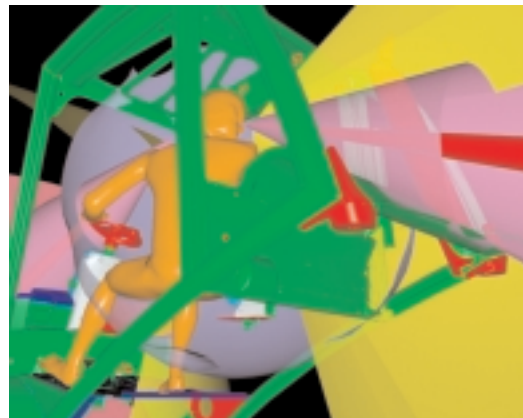
Abb. 5: Analyse der Haltungen und Sichtbereiche in einem Gabelstapler mit Hilfe von RAMSIS
