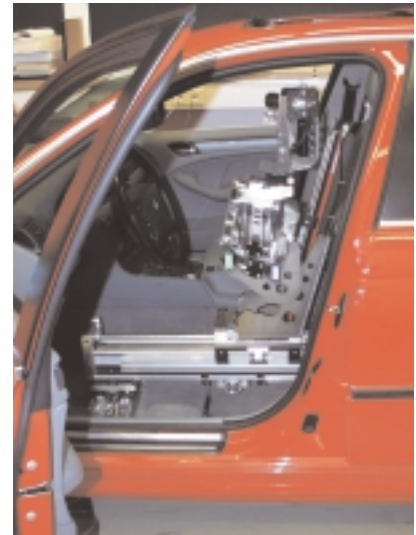
Abb. 4: Messroboter im Fahrzeug montiert.
