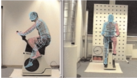
Abb. 3: Erstes Bildpaar einer Bewegungssequenz. Die angepasste Haltung initialisiert die automatische Bewegungsanalyse.
