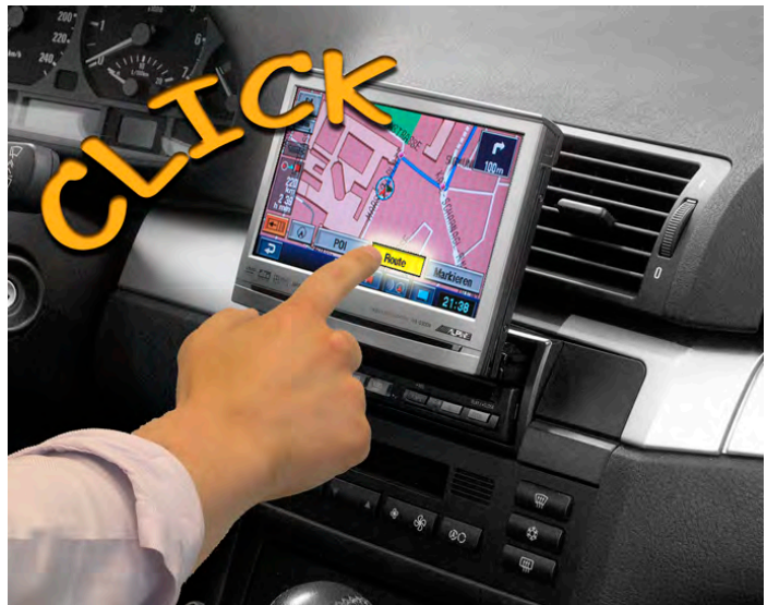
Abb.: 3: Touchscreen im Fahrzeug mit haptischer Rückmeldung
