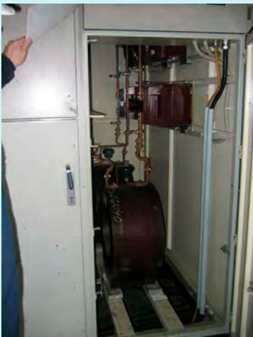
Abb.: 3: 25 kV-Schaltanlage eines Braunkohlebaggeres
