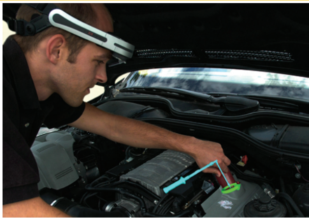
Abb. 2: Augmented Reality in der Montage (Internetseite metaio GmbH, 2006)
