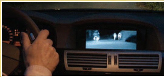
Abb. 2: Infrarot-Bild des Night-Vision Gerätes
