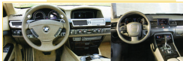
Abb. 5: iDrive (BMW 7er-Reihe, links) und MMI (Audi A8, rechts)
