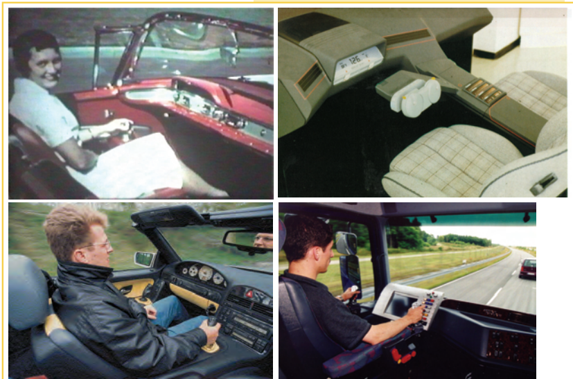
Abb. 11: Joystick-Steuerung für Kraftfahrzeuge: Versuchsfahrzeug von GM (links oben), Design-Vorschlag von Lammel (1983; rechts oben) Mercedes-Benz Versuchsträger (Eckstein, 2000; links unten), DC für Nfz (rechts unten)
