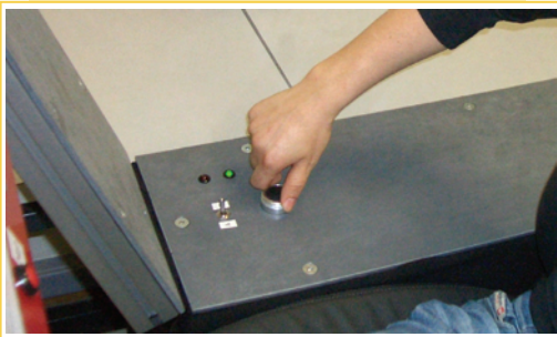
Abbildung 6: Versuchsaufbau mit dem Simulator für rotatorische Bedienelemente, integriert in eine Sitzbox.
