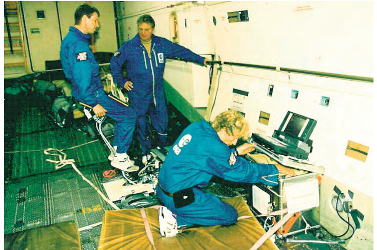
Abb. 22: Messaufbau für den MSC im Einsatz bei einem Parabelflug.
