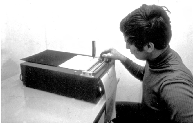
Abb. 6: FS 1 genannte einfache Versuchseinrichtung zur Darstellung der menschlichen Regelleistung.
