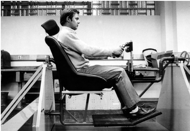
Abb 10: Einachsiger Schwingungssimulator, der u.a. bei der Dissertation "Rühmann" zum Einsatz kam (sog. "Ilgmannschaukel")
