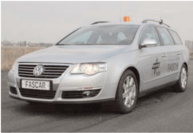
Abbildung 11: FASCar: per Sidestick steuerbarer Versuchsträger des DLR
