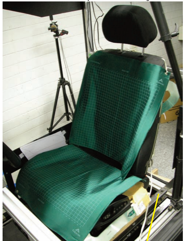
Abbildung 2-4: Foliensensoren zur Messung der Sitzkräfte
