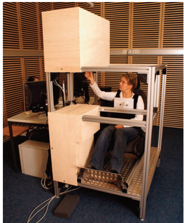
Abbildung 2: Sitzbox zur Durchführung von Versuchen zu haptischer Konstanzleistung. Es können mehrere Simulatoren integriert werden.
