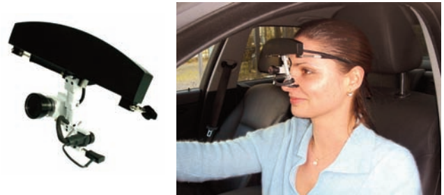
Abbildung 3-1: Links: Die kopfbasierte Blickerfassungseinheit; Rechts: Im Fahrzeug sitzende Probandin, die die Head-Unit trägt
