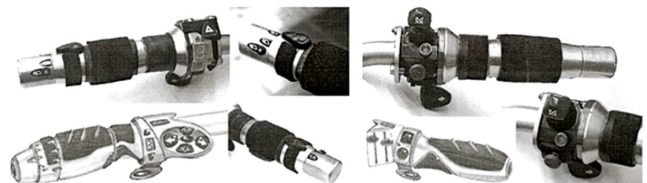
Abb. 11: Nach systemergonomischen Prinzipien gestaltete Bedienelement für die Steuerung eines Motorrads (M. Schell, 2002)
