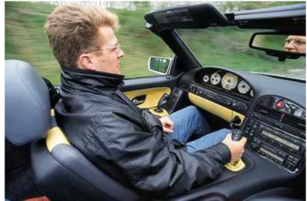
Abb. 10: Mittels als Joystick realisiertem Aktiven Bedienelement zu lenkender Mercedes 500 SL (Eckstein, 2000)
