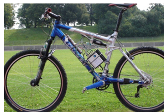
Abb. 5a: Am Fachgebiet entwickeltes Messfahrrad zur Erfassung der beim Mountainbiken auftretenden Lasten an Lenker, Sattelstütze, Pedalen und Naben. Die ermittelten Betriebslasten fließen ein in eine Dauerfestigkeitsprüfung von Rahmen und Komponenten aus CFK.
