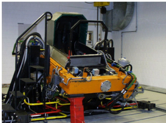
Abb. 5: Zweiachsrotationsschwingungssimulator des LfE, der auch noch nach dem Umzug nach Garching im Einsatz war.
