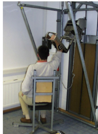
Abb.2: Messapparatur für Kräfte im Schultergelenk
