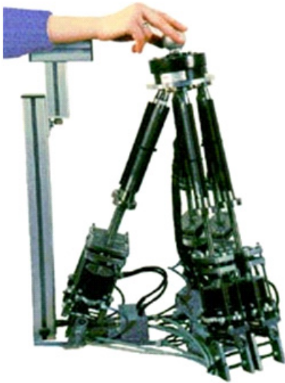
Abb. 8: Sechsdimensionales aktives Bedienelement, genannt „Spinne“
