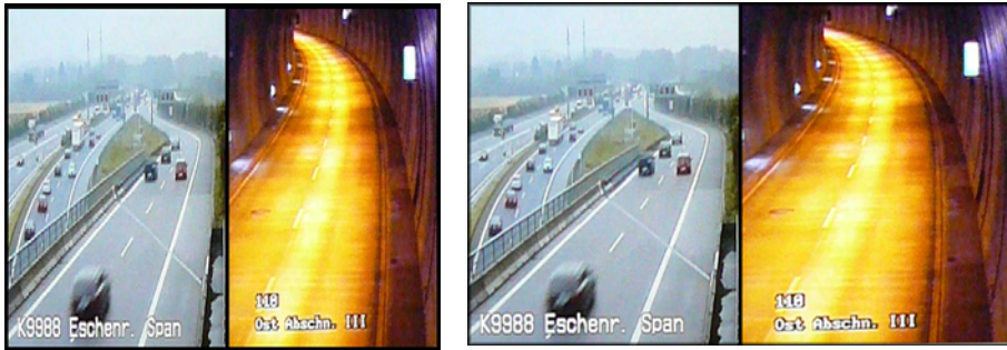
Abb. 5: Splitscreen-Modus zur Darstellung der beiden Videobilder einer Tunnelanlage
