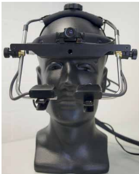
Abb. 1: Pupillometrie-Messsystem EyeLink II™
