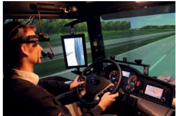
Abb. 2: Dynamischer LKW-Fahrsimulator, Lehrstuhl für Fahrzeugtechnik
