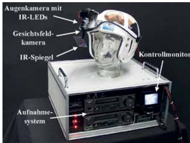
Abb.1: Das Blickerfassungssystem JANUS mit Kopfeinheit und Aufnahmesystem.
