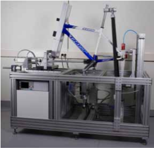
Abb. 2: Fünf-Achsen-Rahmenprüfstand zur Ermittlung der Betriebsfestigkeit von Fahrradrahmen
