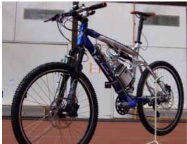
Abb. 1: Mountainbike Meßrad mit Sensoren an Kurbeln, Sattelstütze, Radachsen, Lenkervorbau.
