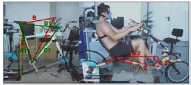
Abb. 6: Spirometrie (Atemgasanalyse) zur Ermittlung des metabolischen Verbrauchs beim Fahren mit einem Liegerad
