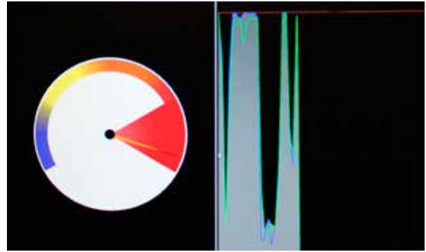
Abb. 4: Die Pupillometrie im Laborversuch: Schon während des Versuchs kann der aktuelle Wert (links) und der Verlauf (rechts) der kognitiven Beanspruchung des Probanden abgelesen werden.
