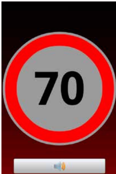
Abb. 6: Hinweis im Portraitmode. Der Fahrer hat die erlaubte Geschwindigkeit mehr als geringfügig überschritten
