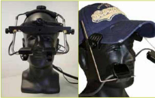
Abb. 3: Das Tragegestell des Eye-Trackers EyeLink II (links) wurde konstruktiv verbessert um den Tragekomfort zu erhöhen (Ulherr, 2012)
