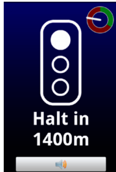
Abb. 2: Ankunftshinweis im Portraitmode. Die „Heuerampel“ in der rechten oberen Ecke zeigt den aktuellen Zustand der nächsten Ampel. Die Vorausberechnung hat ergeben, dass mit einer verkehrssicheren Fahrweise die nächste Ampel nur noch bei Rot zu erreichen ist. Dem Fahrer wird daher „Halt in 1400m“ angezeigt.
