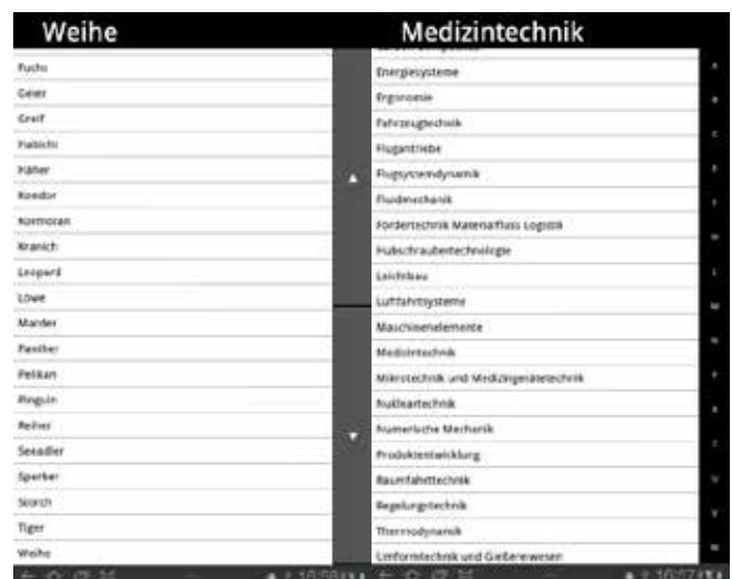
Abbildung 2: Die Bedienvarianten „Pfeiltasten“ und „direkte Manipulation mit Indexleiste“
