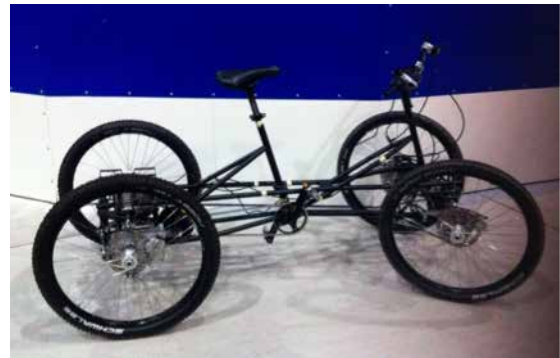
Abbildung 7: Versuchsträger der gewerblichen Variante des Quadrad (ohne Batterie, Verkabelung und Transportboxen)
