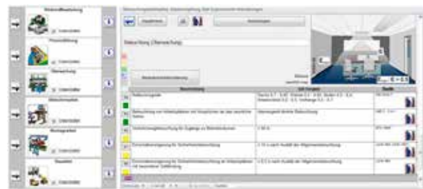
Abbildung 6: Struktur des Arbeitsplatzmodules in EKIDES und Auszug eines Datenblattes - Beleuchtung für Überwachungsarbeitsplatz
