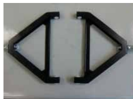
Abbildung 5: Oberer (links) und unterer (rechts) Querlenker der hinteren Radaufhängung
