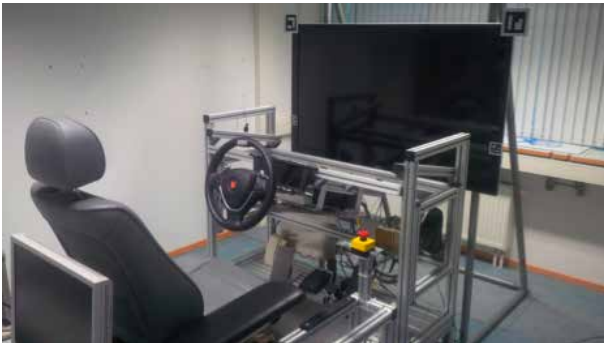
Abb.7: Mobiler Fahrsimulator des LfE
