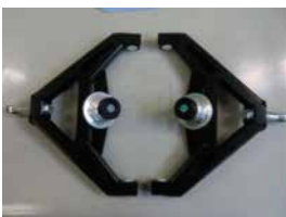
Abbildung 5: Oberer (links) und unterer (rechts) Querlenker der hinteren Radaufhängung
