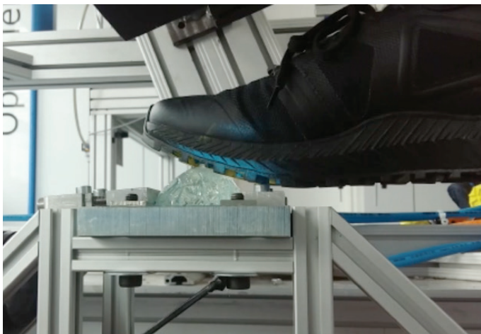
Abbildung 3: Ein Trailrunningschuh wird mit Hilfe des TUM-Track-Testers über den Glasstein bewegt
