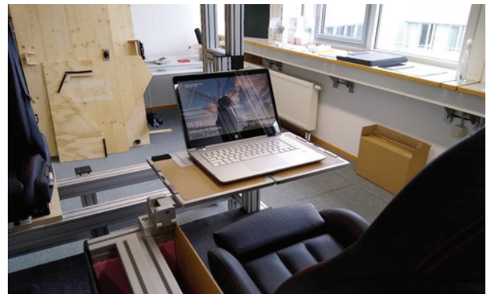
Abbildung 6: Versuchsaufbau des Klapptischsystems in der Sitzkiste.
