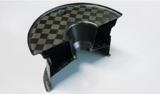
CFK-Felge als Schnittmodell aus Prepreg-Autoklavenfertigung
