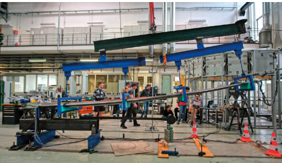
Fig. 2: Vorversuch mit einer Belastung von J = 1 , entspricht einer Beschleunigung von 10 g
