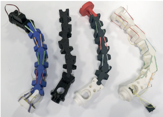
Fig. 2: Prototyp für ein Robotermodul, das seine Steifigkeit über einen Motor verändern kann
