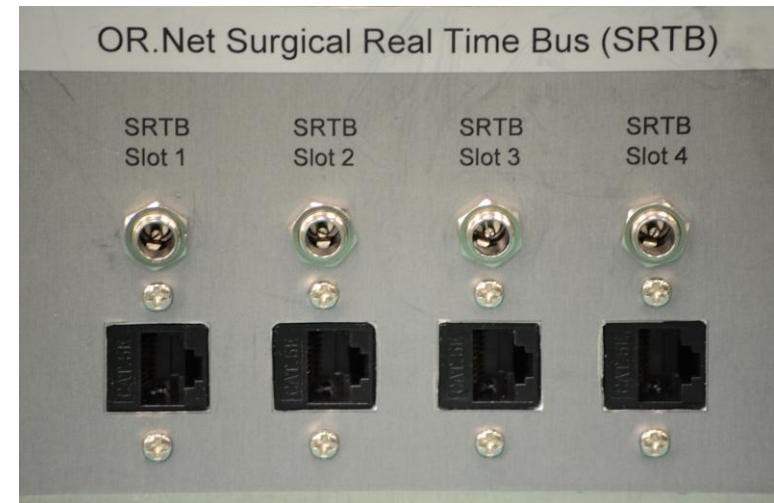
Abb. 14: (Rückansicht Master) - Ports für die Anbindung des Echtzeit-Bus. Mehrere Äste möglich.
