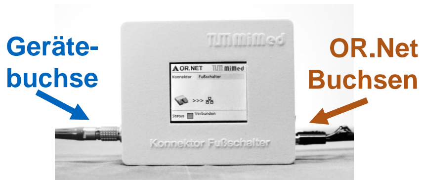
Abb. 9: Konnektor Fußschalter mit geräteeigenen Buchsen links und OR.Net Buchsen Rechts
