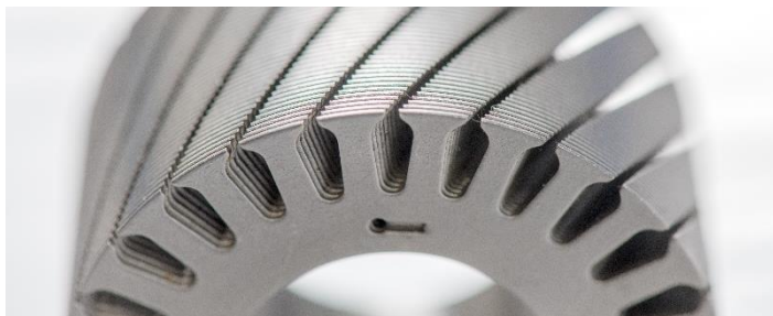
Abbildung 1: Rotorpaket aus gestapelten Elektroblechen
