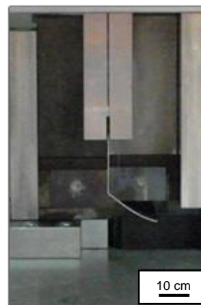
Abbildung 1: ECAP-Werkzeug; ein Blechzuschnitt wird durch einen gewinkelten Kanal gepresst, um die Mikrostruktur des Blechs gezielt zu modifizieren.
