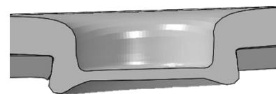
Abbildung 3: Rotationsclinchpunkt mit Vorloch in der Simulation
