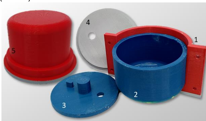
Abb. 1 Indirect Rapid Tooling Ansatz; Gießform mit Hartform (1), Silikon gießform (2), Silikon- (3) und FDM Deckel (4) sowie FDM Formnegativ (5)
