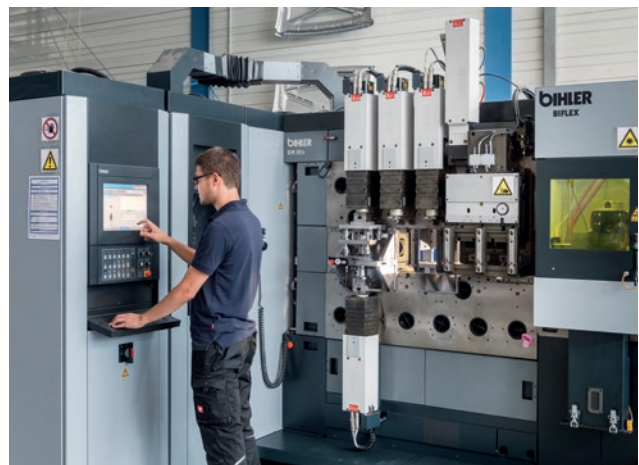
Start einer Versuchsreihe am Stanz-Biege-Automat Bihler BM 306
