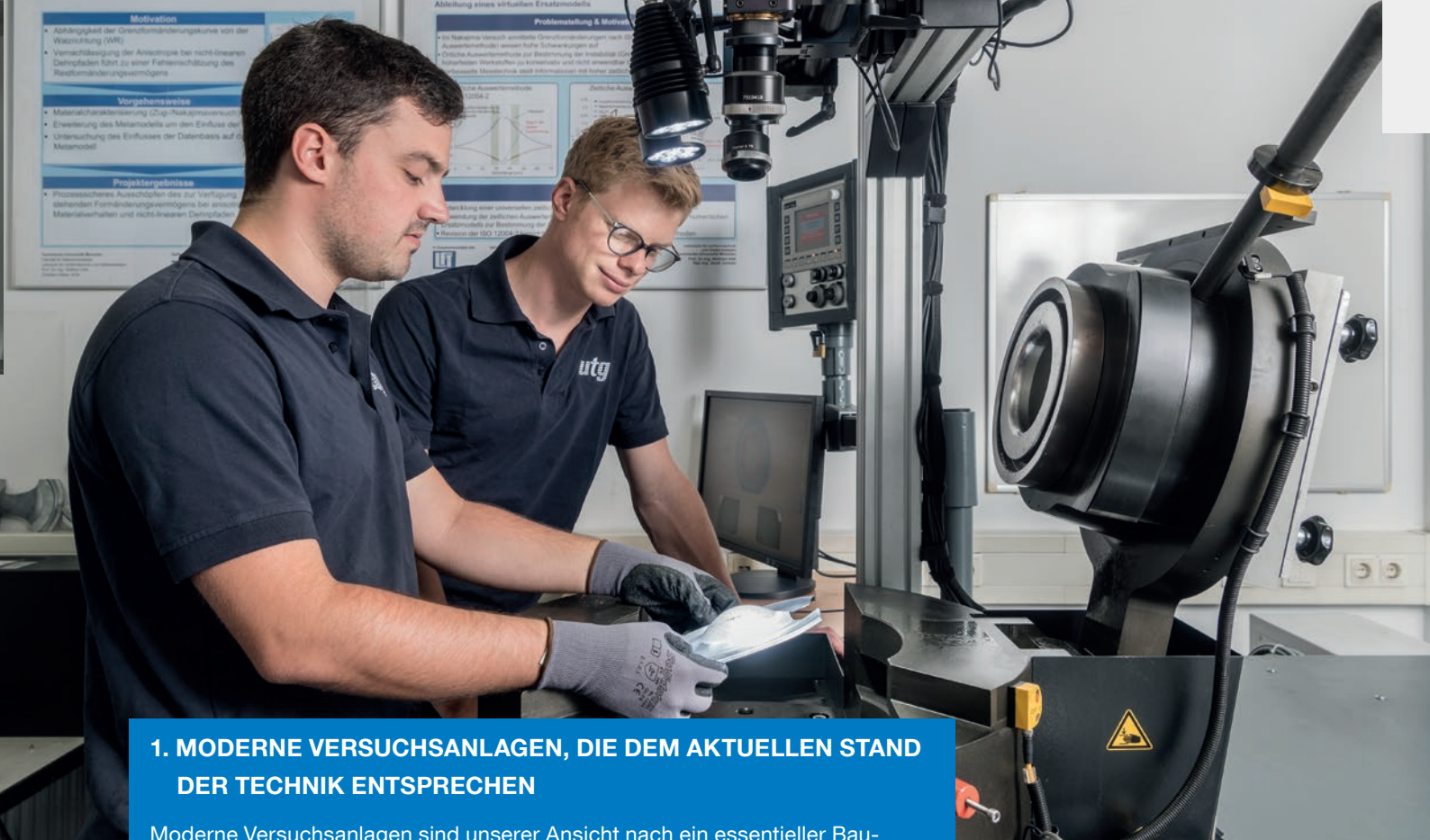
Nakajima-Versuch auf der Blechumform-Prüfmaschine BUP 1000 der Firma Zwick
