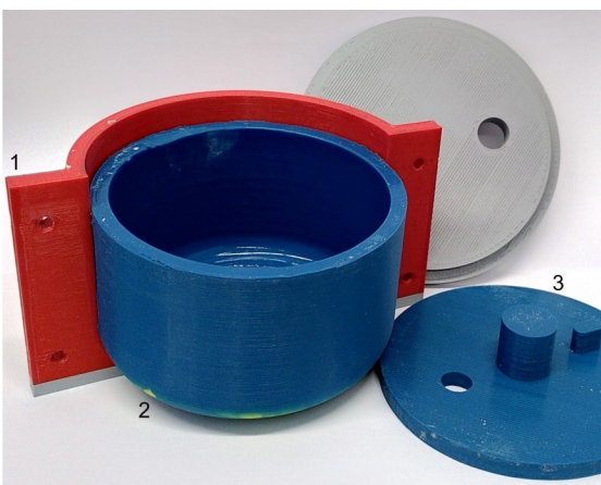
Abb. 1: Gießform nach Indirect Rapid Tooling Ansatz.
