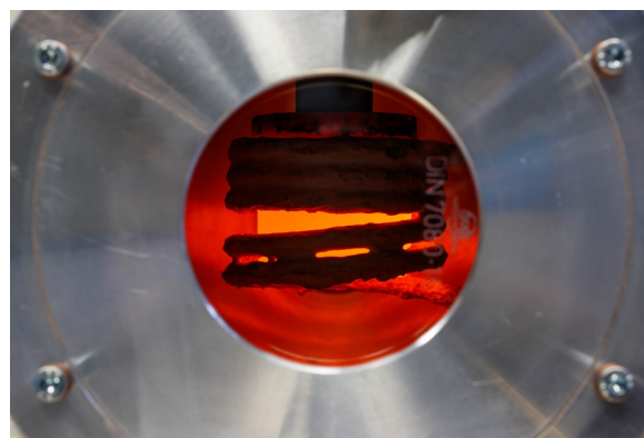
Abb.2: Heizkammer mit Induktionsspule, Foto: utg
