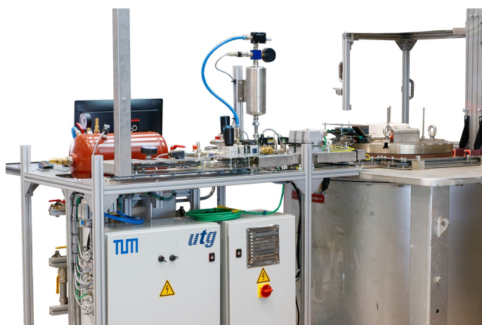
Abb. 1: Niederdruckgießanlage zum Gießen von Asynchronrotoren, Foto: utg
