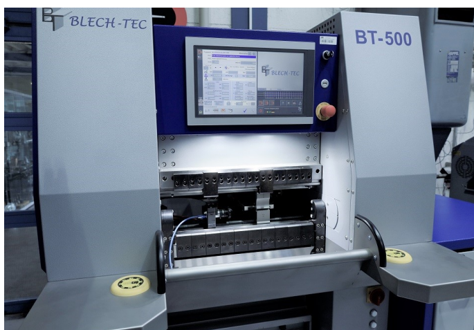
Die kompakte Biegemaschine BT-500 der Fa. Blech-Tec für Blechkleinteile, Foto: utg
