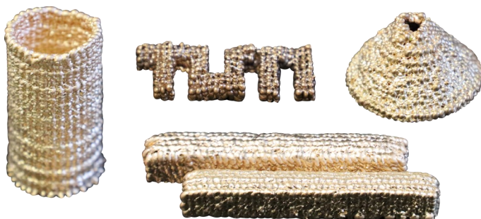
Abb. 1: Mittels MJT additiv gefertigte Bauteile aus Reinkupfer und Bronze, Foto: utg
