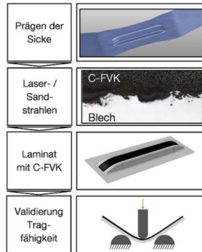
Schritte zur Fertigung und Validierung der Hybridsicken, Bild: utg & IPEK
