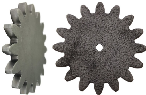
Feingeschnittene Zahnräder (Normalmodul: 4,5 mm, Kopfkreisdurchmesser: 82, 45 mm, Zahnbreite: 6 mm), Foto: utg
