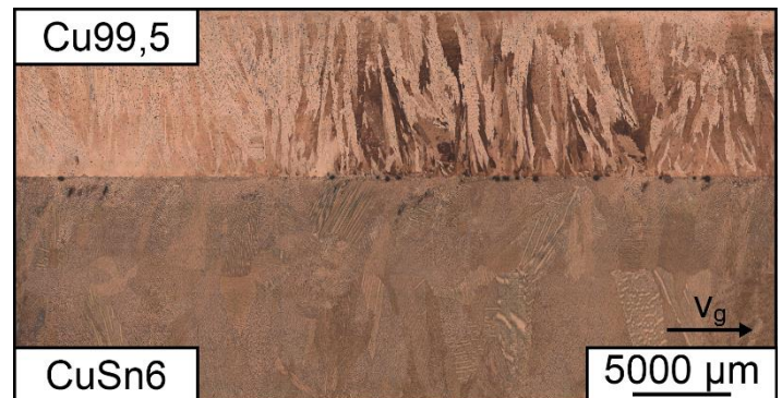
Abbildung 3: Schliffbild eines Cu99,5/CuSn6-Schichtverbundes
