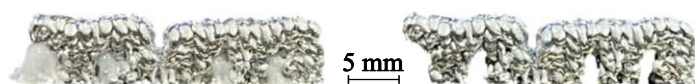
Abbildung 1: Links: TUM-Logo aus Aluminium mit einer monolithischen Salzstützstruktur. Rechts: Selbes Bauteil nach Entfernung der Stützstruktur. (Kirchebner et al., 2023)
