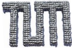
Abbildung 1: Mittels MJT additiv gefertigtes Logo der TUM
