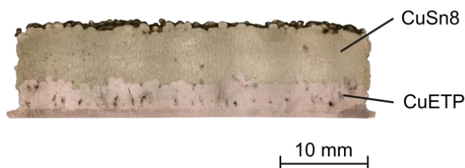
Abbildung 1: Durch Molten Metal Jetting hergestelltes Multimaterialbauteil aus CuSn8 und CuETP.
